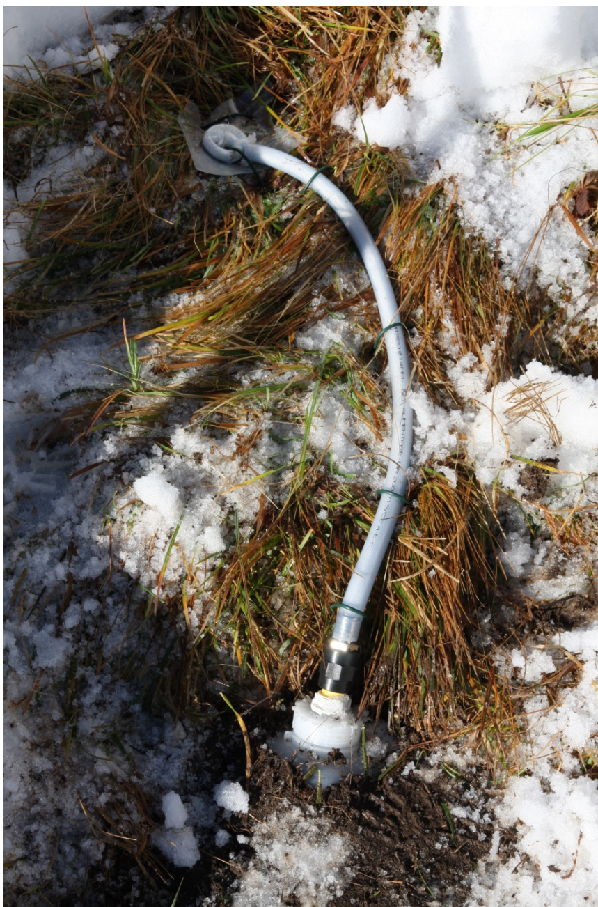
Рисунок 18.1 - Пример установки отдельного пассивного пробоотборника (Южный Тироль).
